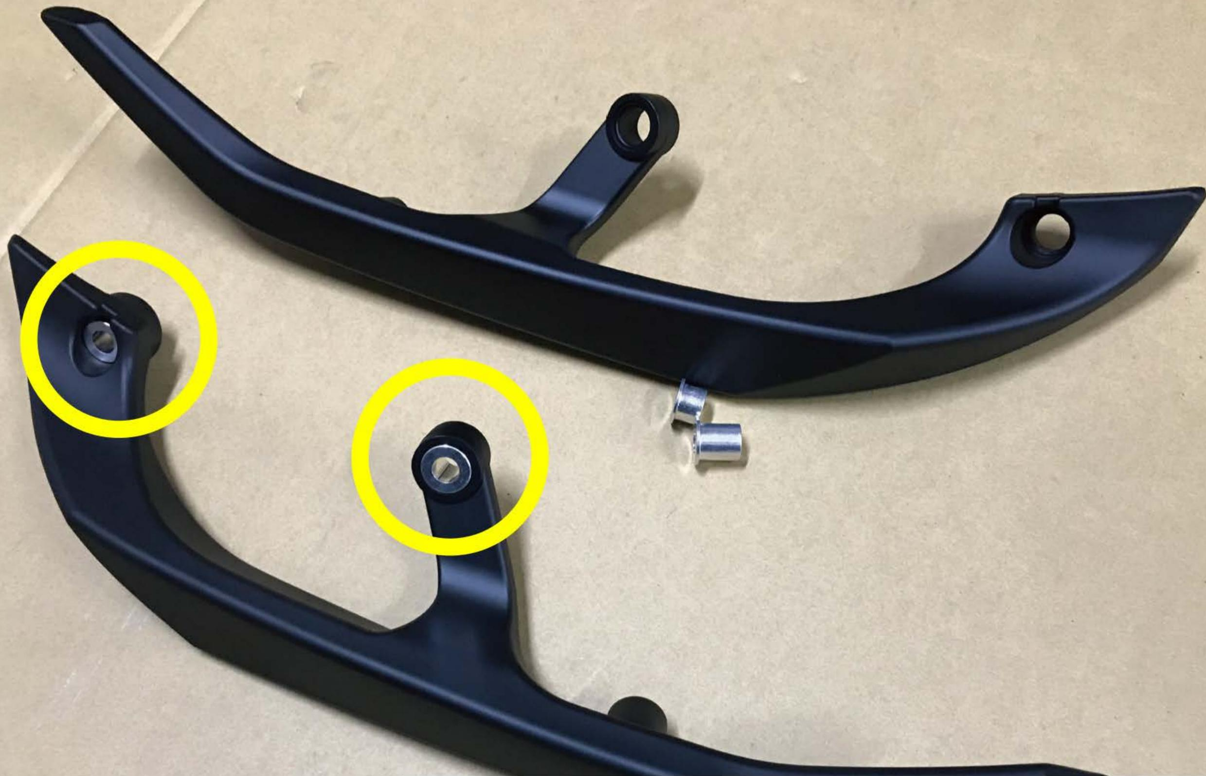
❖ SMAX 套筒請將長的套在後方
