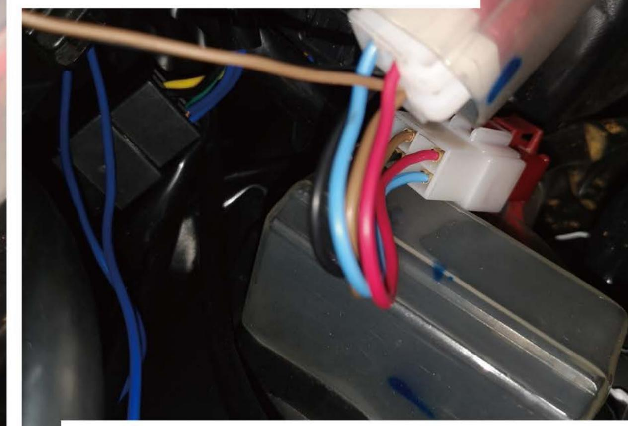
❖ 測試過後確認開關各項功能都正常 即可將電線外橡膠套裝回、綁上束帶 再將車殼裝回鎖
