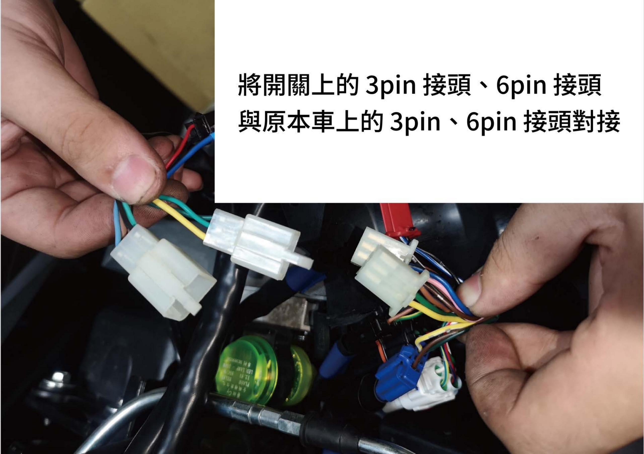
● 將開關上的 3pin 接頭、6pin 接頭 與原本車上的 3pin、6pin 接頭對接
