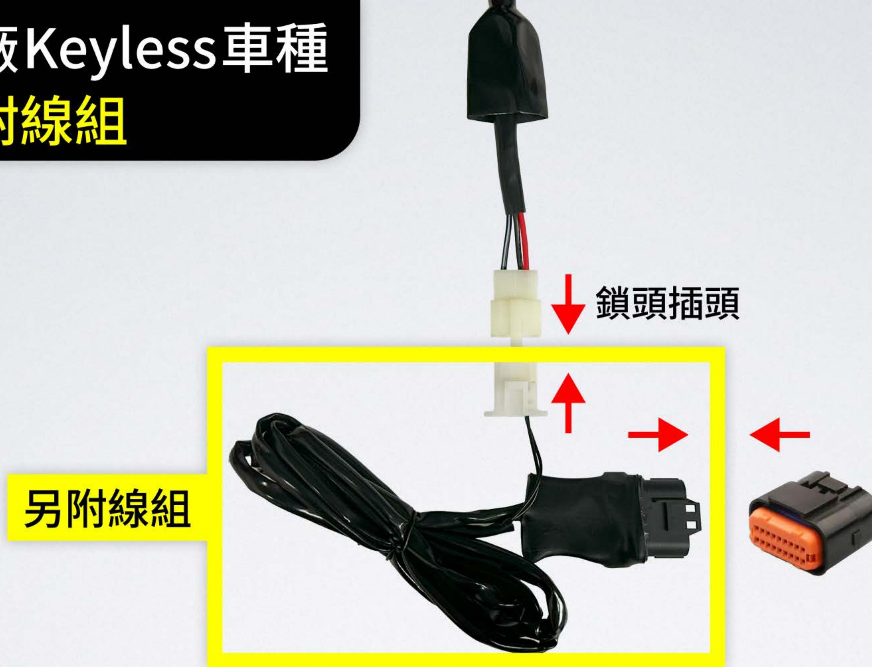
原廠 Keyless 主機 (車輛左後方) 先拆除配線，
