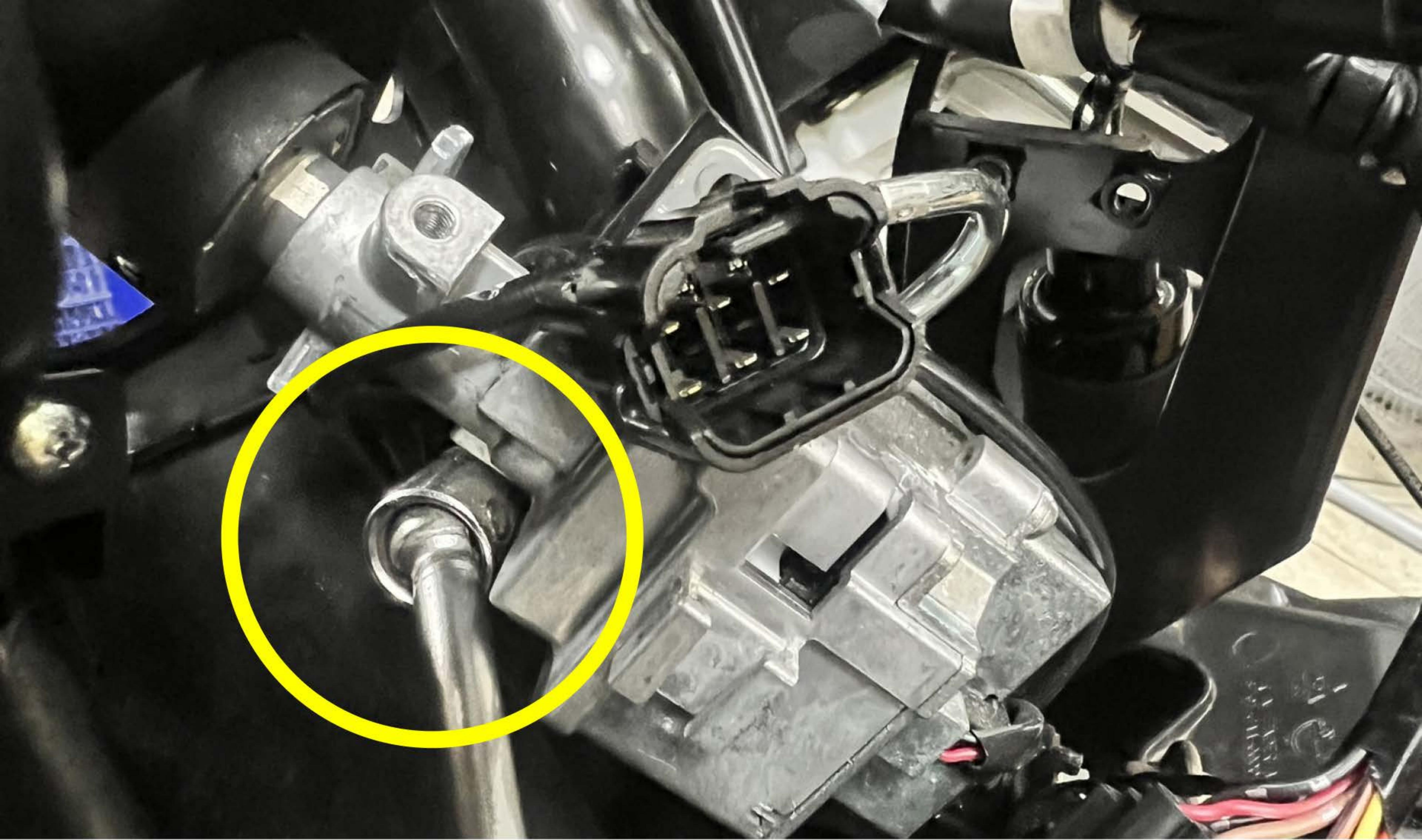
③ 拆下鎖頭螺絲，並拆下原廠鎖頭組
