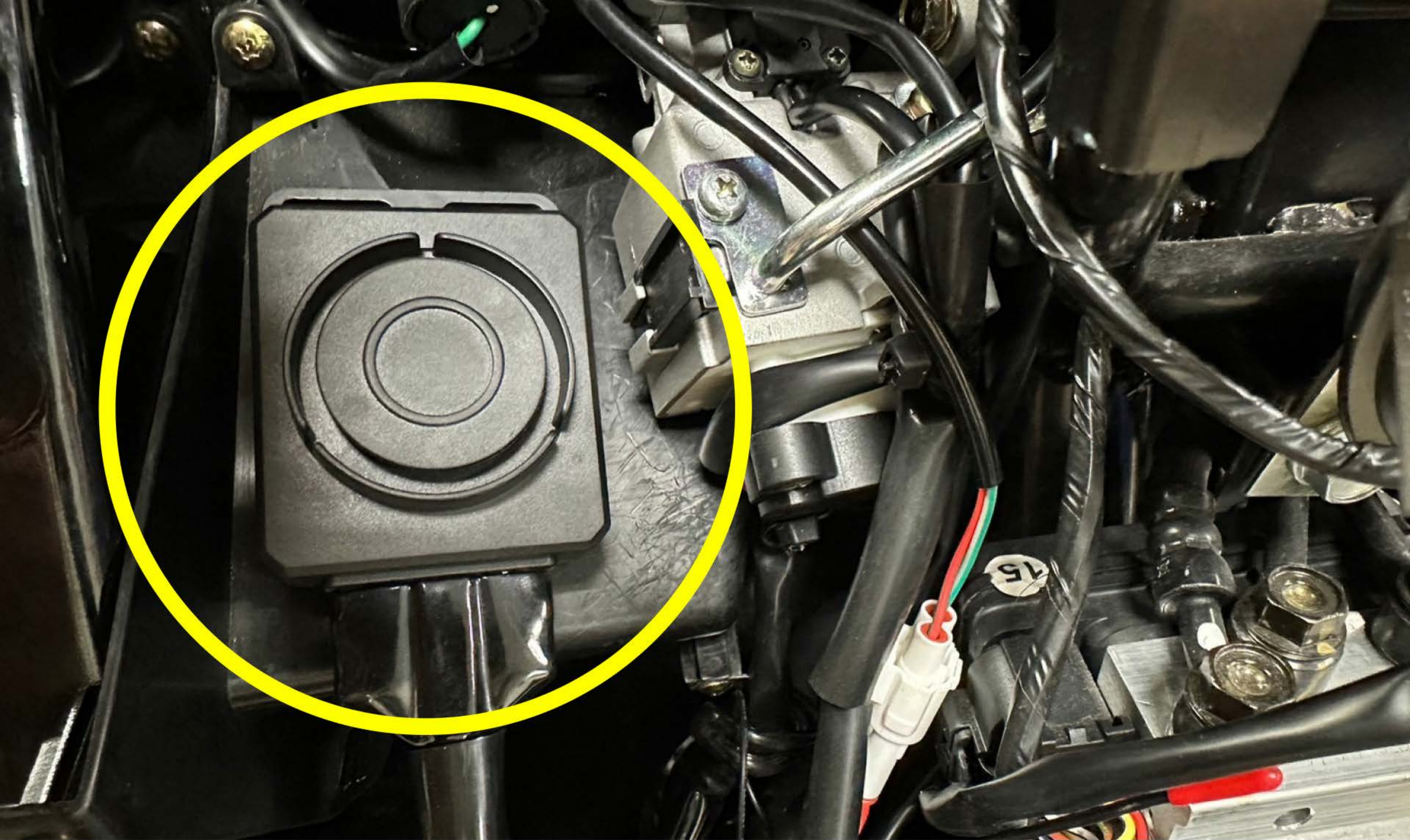
16 主機安裝位置
