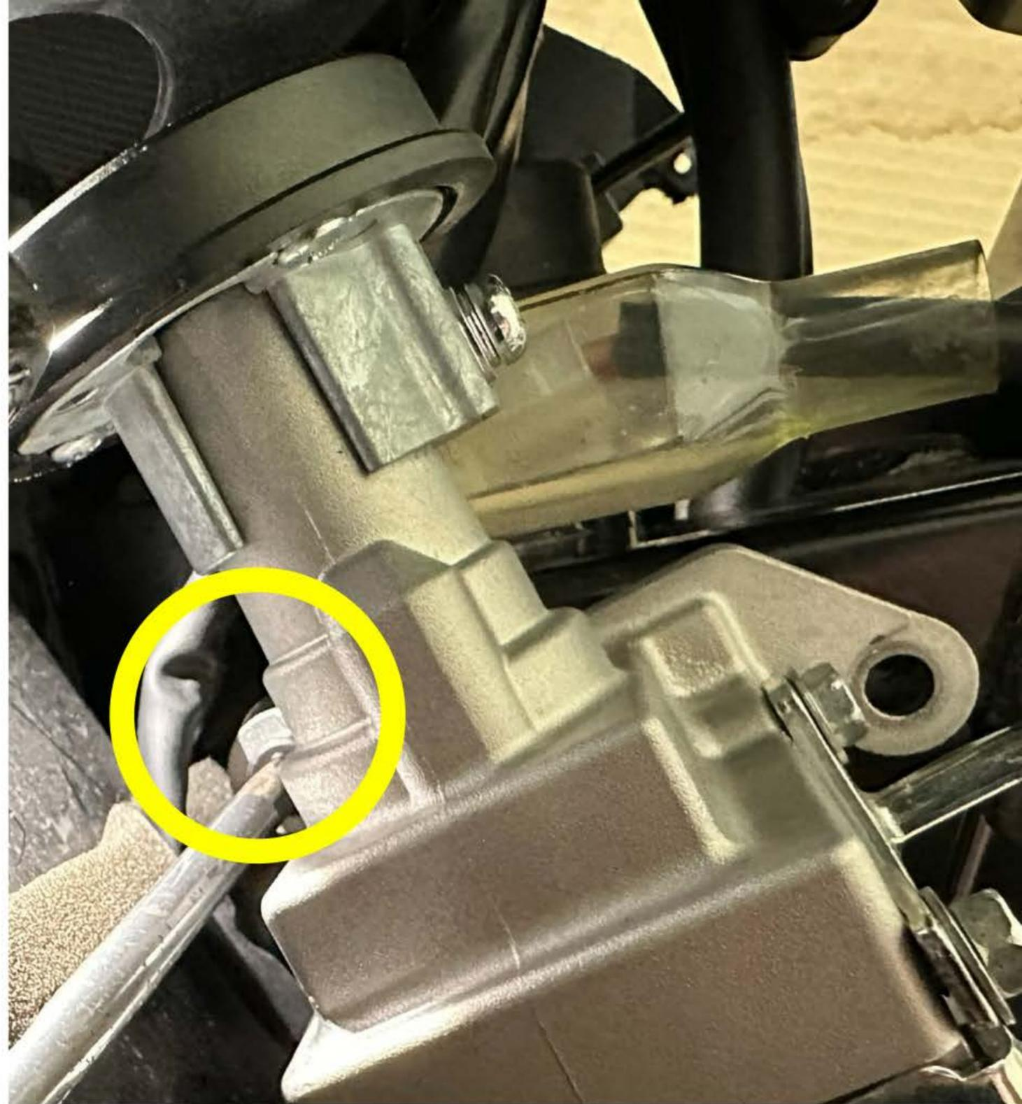
**❶ 拆除原鎖頭上下固定螺絲，並卸下鎖頭**
